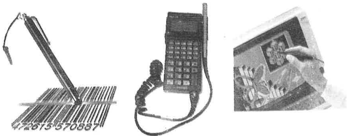
الشكل (2-14) أشكال من القلم الضوئي واستخداماته
